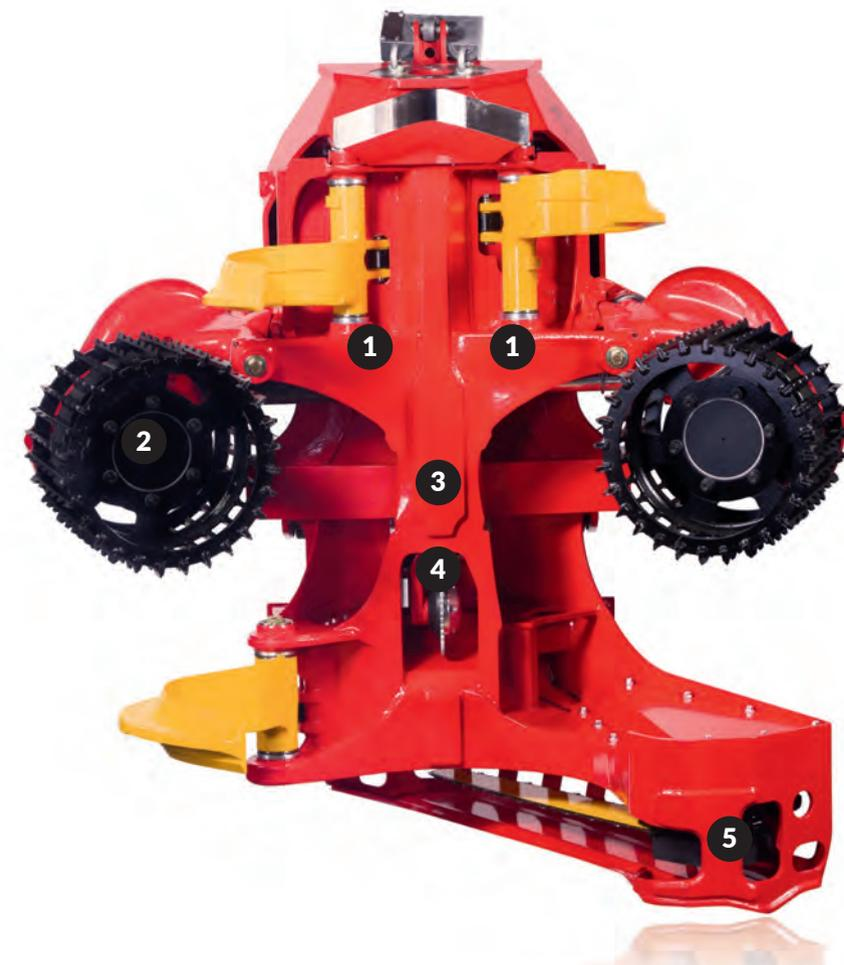
1. Надежные бесконтактные кодирующие устройства для измерения диаметра установлены в полностью герметичных стальных корпусах, расположенных внутри рамы для обеспечения максимальной защиты и долговечности.
