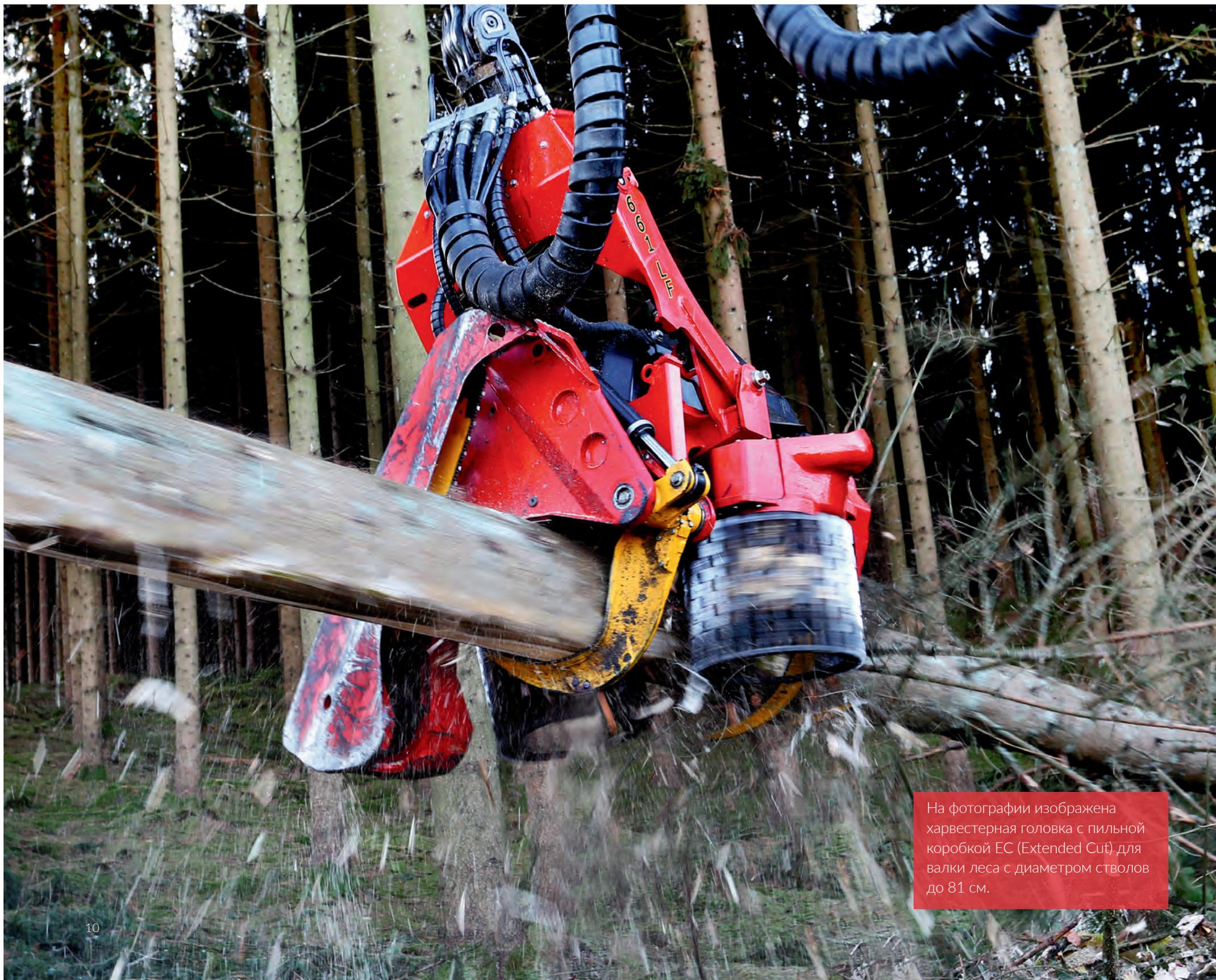
На фотографии изображена харвестерная головка с пильной коробкой EC (Extended Cut) для валки леса с диаметром стволов до 81 см.
