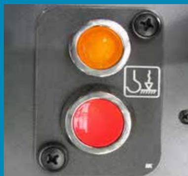
Система аварийного опускания крюка является стандартной для обеспечения безопасности при любых условиях.
